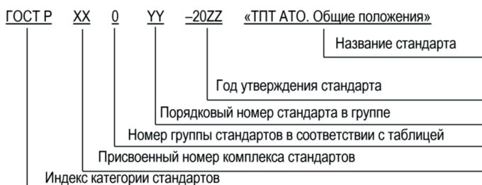
Рис. 4. Схема обозначения национальных стандартов ТПТ АТО
