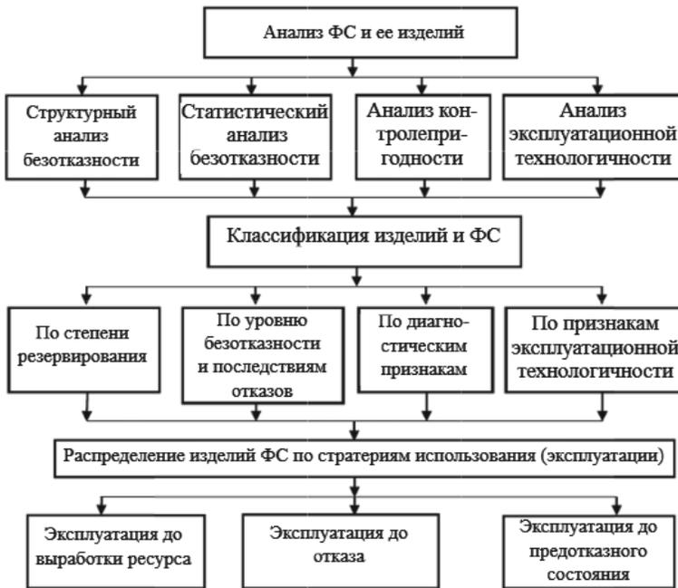
Рис. 3.6. Последовательность действий при выборе стратегий использования изделий ФС
