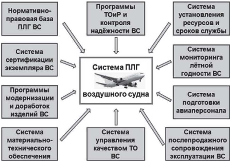
Рис. 4.2. Система поддержания лётной годности ВС на этапе эксплуатации
