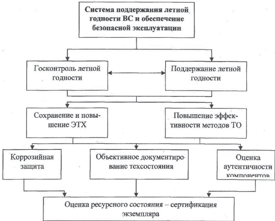
Рис. 2.11. Система обеспечения безопасности эксплуатации ВС
