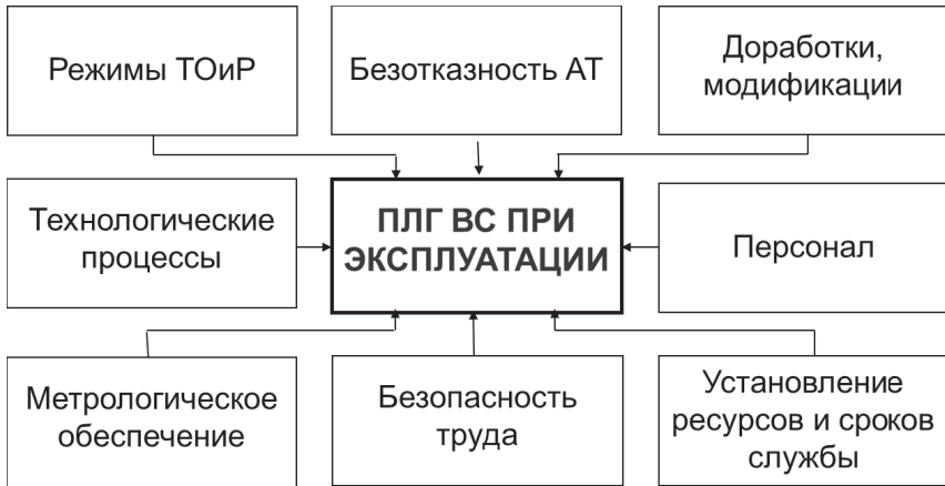
Рис. 4.4. Факторы, обеспечивающие ПЛГ ВС при эксплуатации
