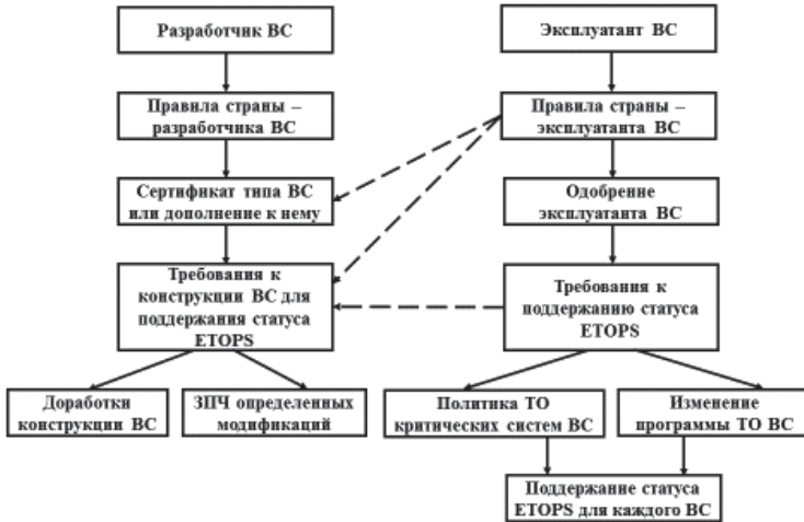
Рис. 4.8. Схема взаимодействия разработчика и эксплуатанта по Программе «EDTO»
