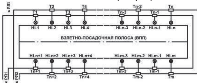
Рис.3.2. Схема подключения к РЯ огней ВПП.
