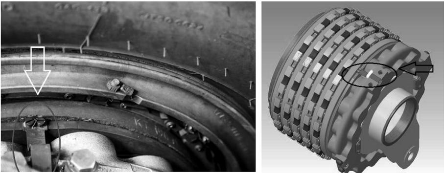
Рис. 10. Указатель износа тормозных дисков колес основной опоры шасси самолетов семейства Ту-204/214
