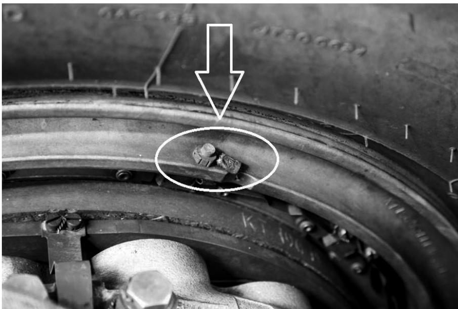
Рис. 11. Термосвидетель (сигнализатор превышения предельных температур) колеса основной опоры шасси самолетов семейства Ту-204/214
