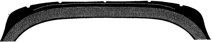
Рис. 6. Равномерный износ при нормальном внутреннем давлении в шине
