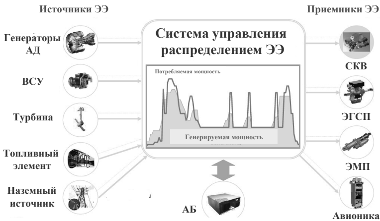
Рисунок 2.2 – Концепция SmartGrid авиационной системы электроснабжения
