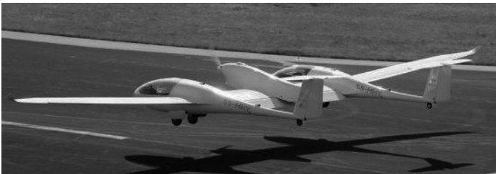
Рисунок 2.12 – Электрический самолёт на водородных топливных элементах H 2 .
