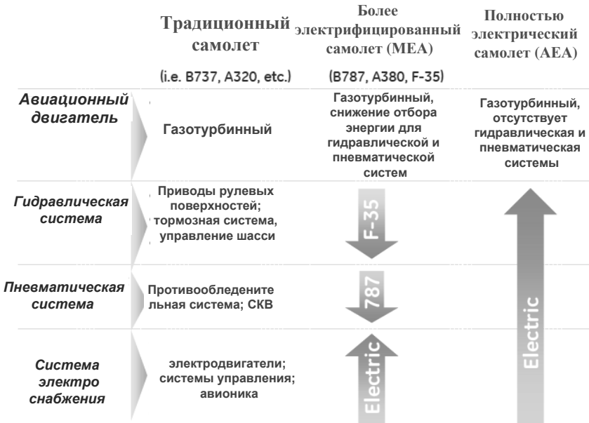
Рисунок 1.4 – Программа полной электрификации самолета
