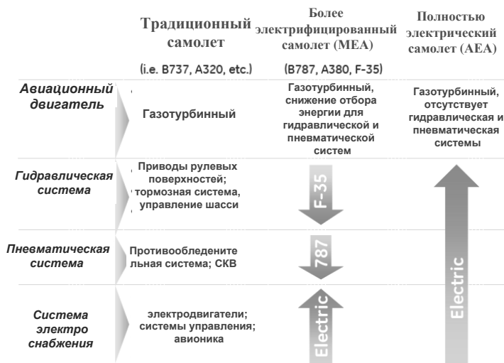
Рисунок 2.1 – Программа полной электрификации самолета
