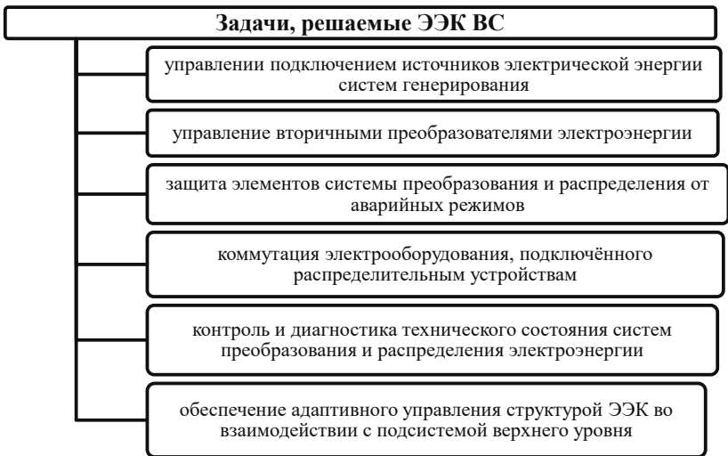
Рисунок 1.15 – Задачи, решаемые электроэнергетическими комплексами воздушных судов
