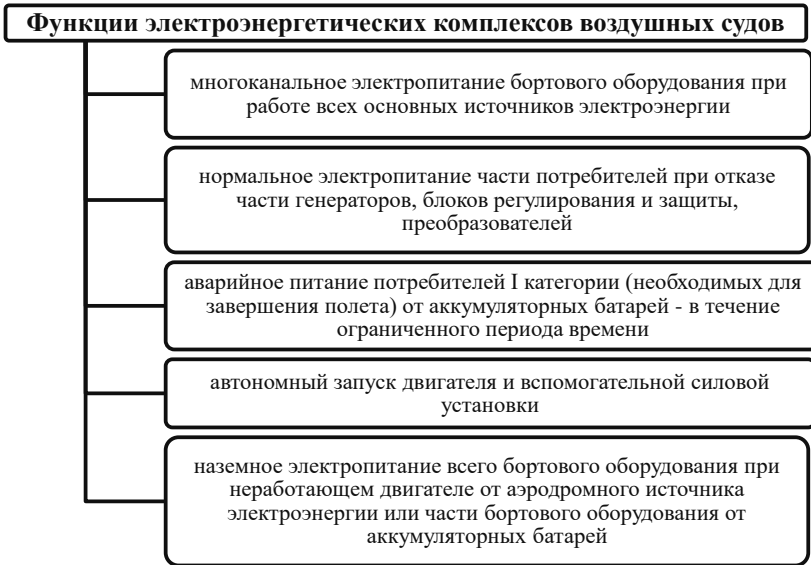
Рисунок 1.14 – Функции электроэнергетических комплексов воздушных судов
