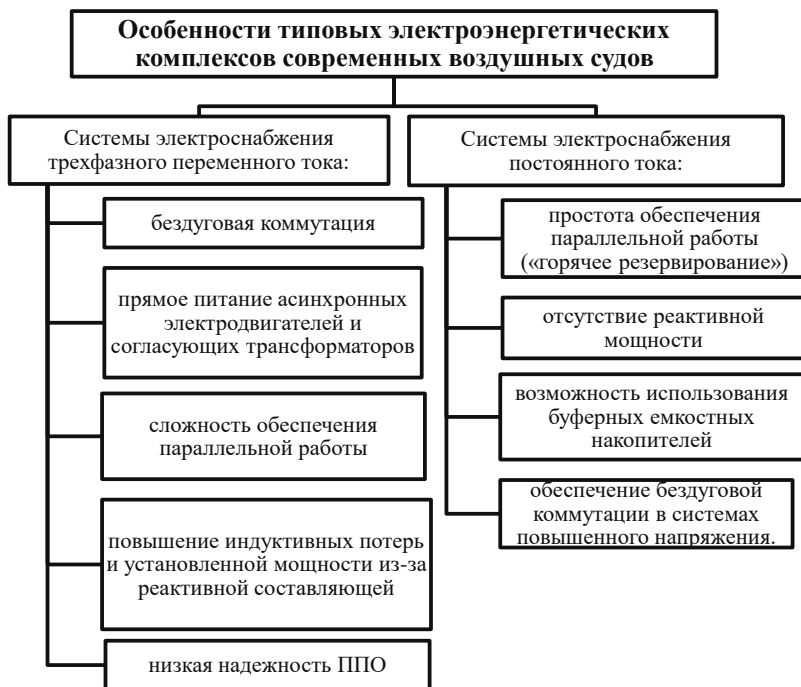
Рисунок 1.19 – Особенности типовых ЭЭК современных ВС
