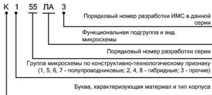
Рис. 2.33. Порядок маркировки интегральных схем
