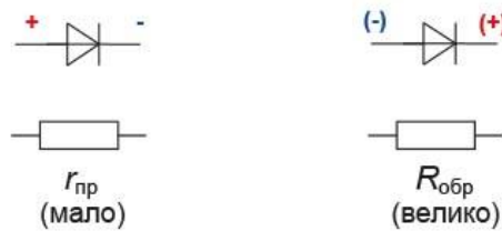
Рис. 2.27. Проверка исправности диода, измерение прямого и обратного сопротивления
