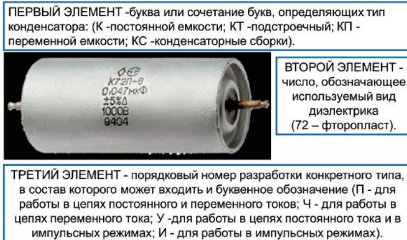
Рис. 2.15. Структура маркировки конденсатора
