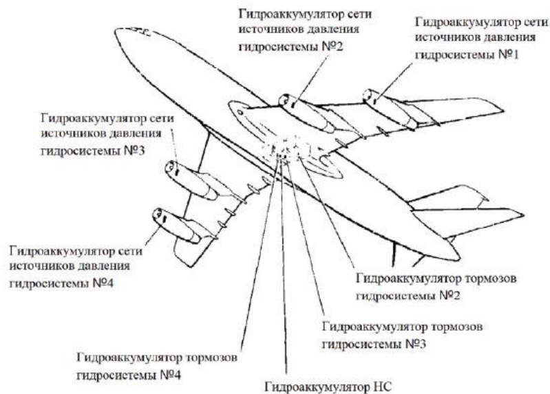
Рис. 10. Расположение гидроаккумуляторов в самолете Ил-86
