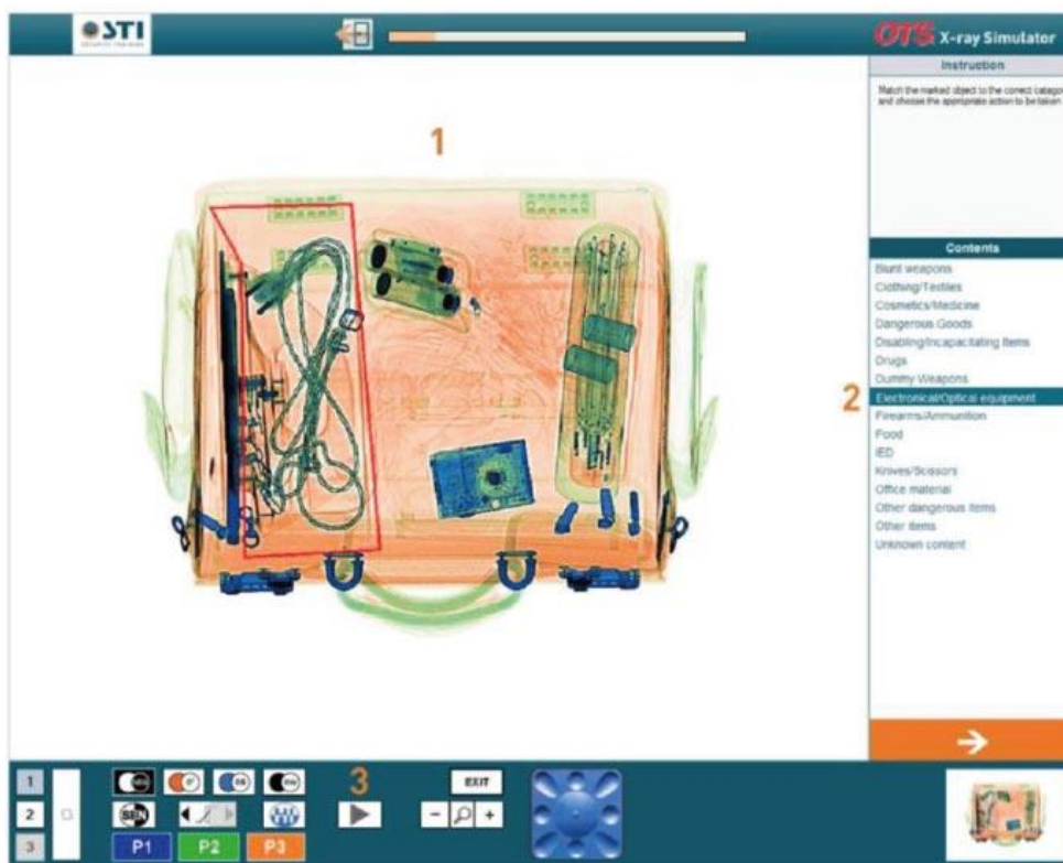
Рисунок 1. Рентгеновское изображение багажа с электрическим устройством ( утюг).
