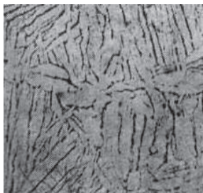
Рис. 16. Микроструктура сплава марки ВТ5-1: зерна \alpha – твердого раствора (x 300)
