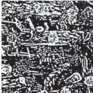
Рис. 25. Микроструктура алюминиевой бронзы марки БрАЖМц10-1-3-1,5: смесь фаз \alpha + \gamma' ( \gamma' - электронное соединение Cu_{32}Al_{19} ) (x 300)
