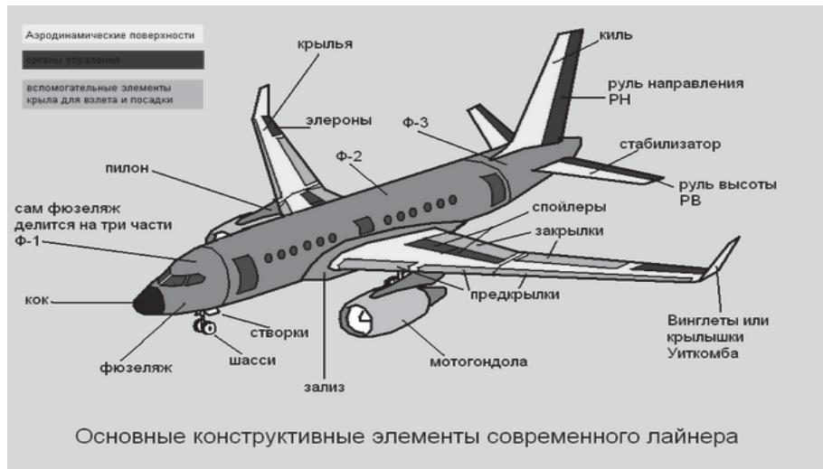
*Рис. 20. Общий вид самолета*
