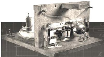
*Рис.1 Аппарат, на котором А.С. Попов впервые продемонстрировал принцип радиосвязи.*
