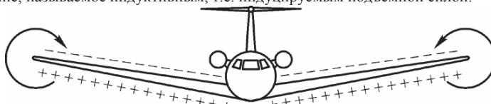
Рис.11. Образование концевых вихрей на крыле конечного размаха
