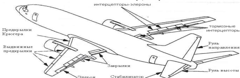
Рис 29. Основные части и конструктивные элементы самолета
