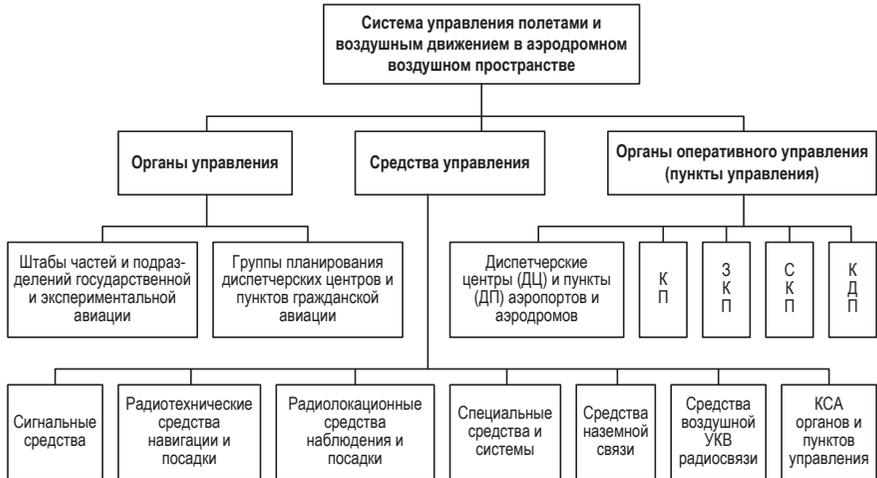
Рисунок 2.1. Состав системы управления полетами и воздушным движением в аэродромном воздушном пространстве
