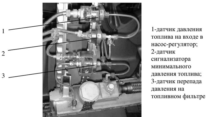
1-датчик давления топлива на входе в насос-регулятор;
