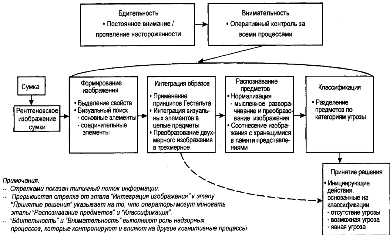
Рис. 3. Когнитивная модель процесса досмотра с помощью рентгеновской установки (авторы Найдерман и Фоубс, 1997 г.)
