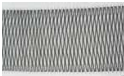
Рис. 3.30 – Экран для защиты от электромагнитных полей
