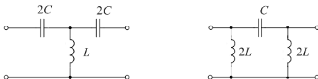
Рис. 3.13 – Электрические схемы фильтров верхних частот
