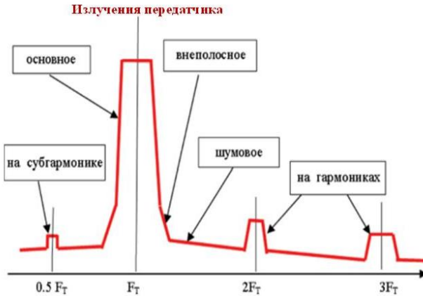
Рис.2.5 – Графическое представление уровней спектрального состава излучения передатчика
