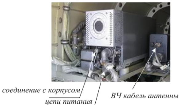
Рис.2.6 – Приемник автоматического радиоконписа на борту ВС
