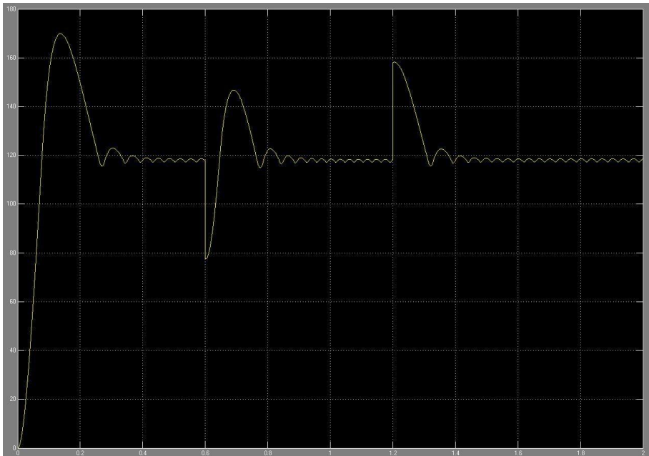
Рис. 2.15. Переходные процессы в релейном регуляторе при включении возбуждения, набросе и сбросе нагрузки
