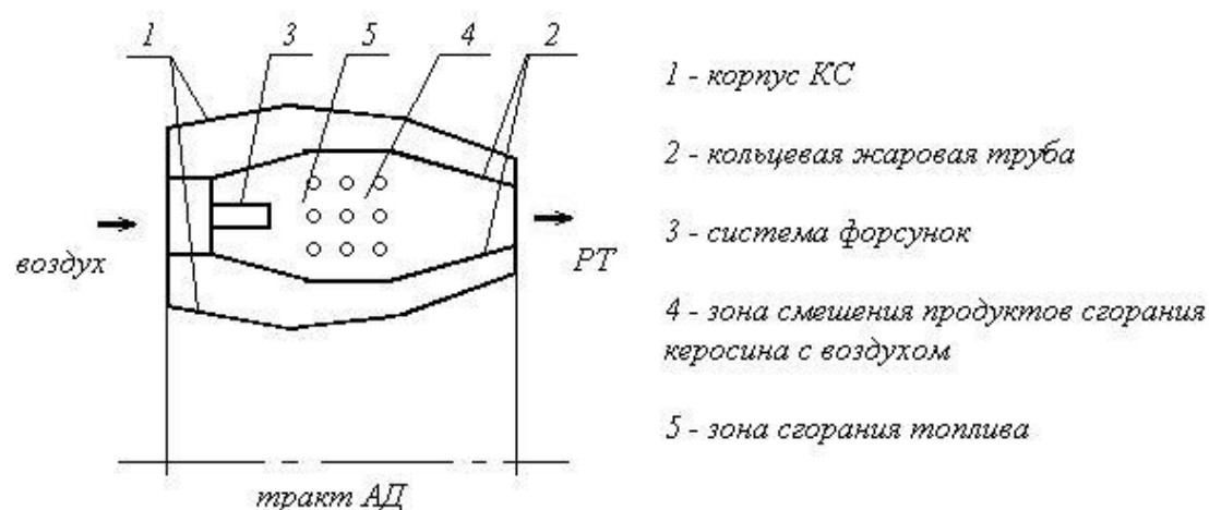
Рис. 12. Принципиальная схема кольцевой КС
