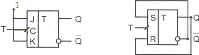
Рис. 3.1. JK-триггер и RS-триггер, включённые как Т-триггер
