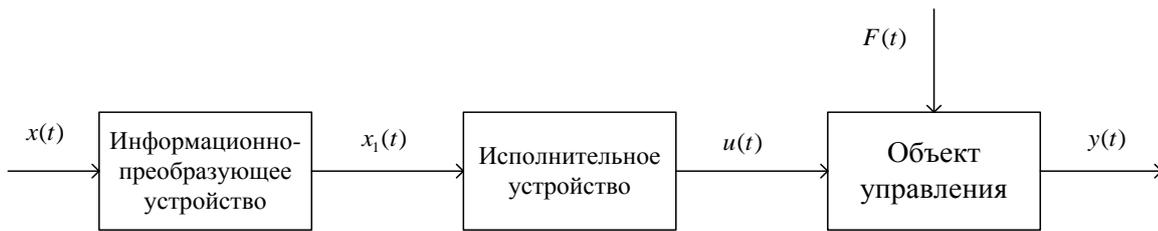
Рис. 16. Функциональная схема разомкнутой системы управления
