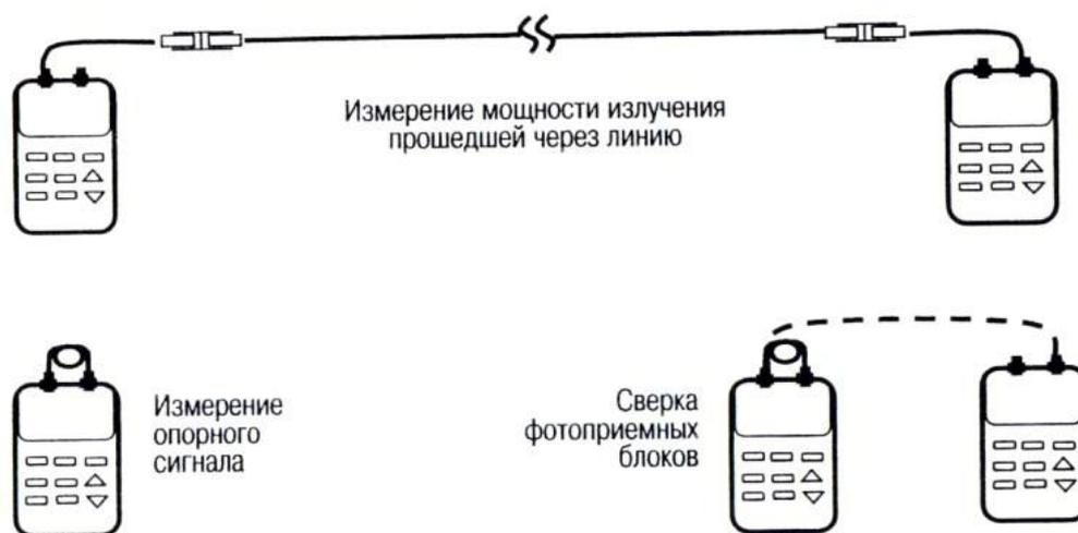
Рис. 2.4. Измерение потерь в ВОЛС с помощью оптических тестеров
