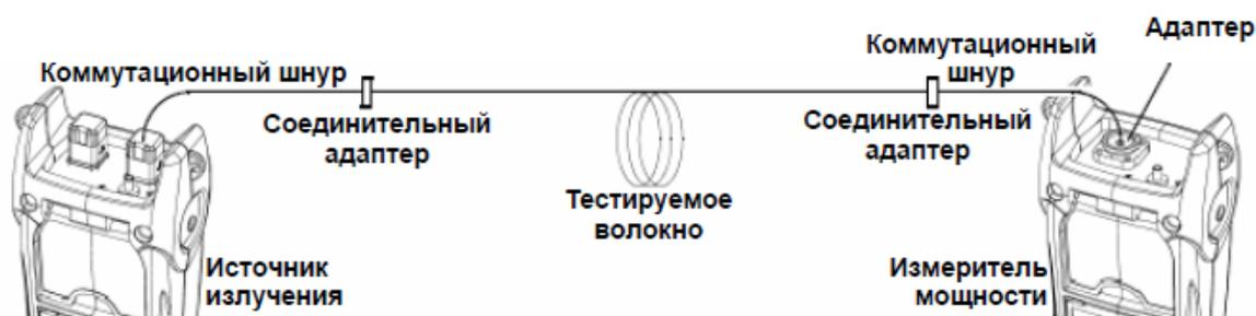
Рис. 2.1. Подключение тестируемого волокна
