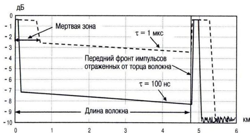
Рис. 3.2. Измерение длины волокна по сигналу отражения от конца волокна
