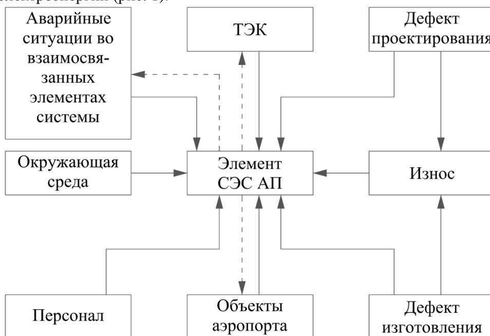
Рис. 1. Схема воздействий и взаимосвязей для элементов СЭС АП
