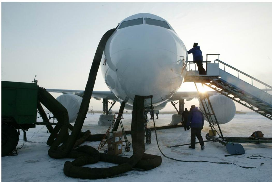
**Рис. 1.** Подогрев отсека авионики ВС А320 от внешнего источника подогревателя УМП350 при температуре окружающего воздуха  $-46^{\circ}\text{C}$
