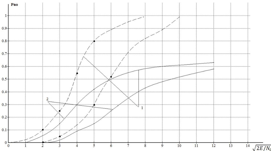
**Рис. 1.** Характеристики обнаружения при флуктуирующем угле ориентации: 1 –  $P_{лт} = 10^{-4}$ ; 2 –  $P_{лт} = 10^{-6}$
