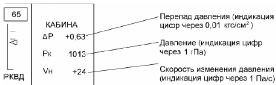
Рис. 4.22. ИНФОРМАЦИЯ О ТЕКУЩИХ ПАРАМЕТРАХ В КАБИНЕ НА ДВИГАТЕЛЬНОМ КАДРЕ ВСПОМОГАТЕЛЬНЫХ ПАРАМЕТРОВ
