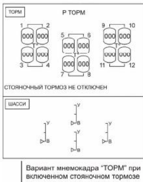
Рис. 4.12. ВИД МНЕМОКАДРА "ТОРМ-ШАССИ"
