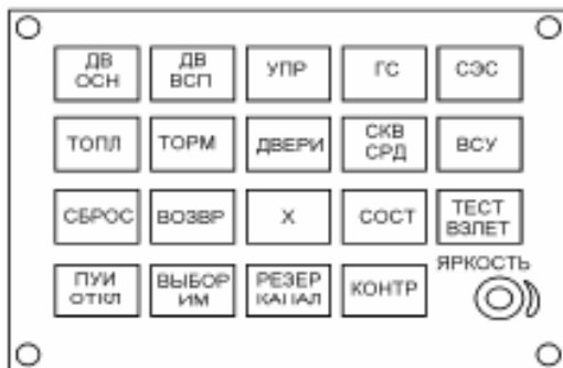
В Пульт управления индикацией (ПУИ) Левый пульт управляет левым ИМ, правый – правым.
