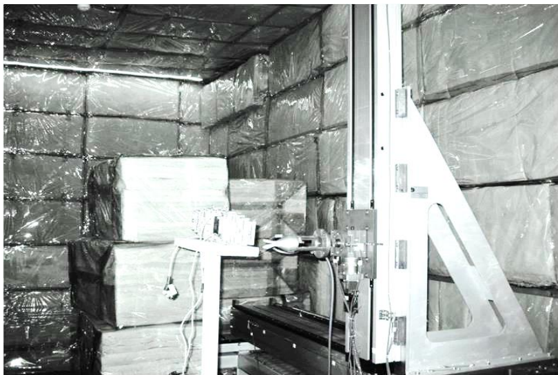
Рис. 4. Измерительная установка планарного сканирования в БЭК
