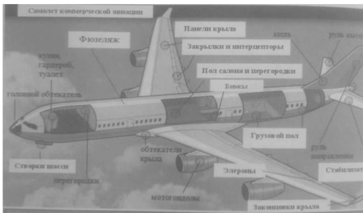
Рис. 2. Детали и агрегаты из КМ в конструкции самолета
