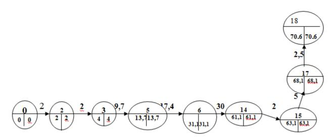
Рис. 3. Пример расчета длины критического пути
