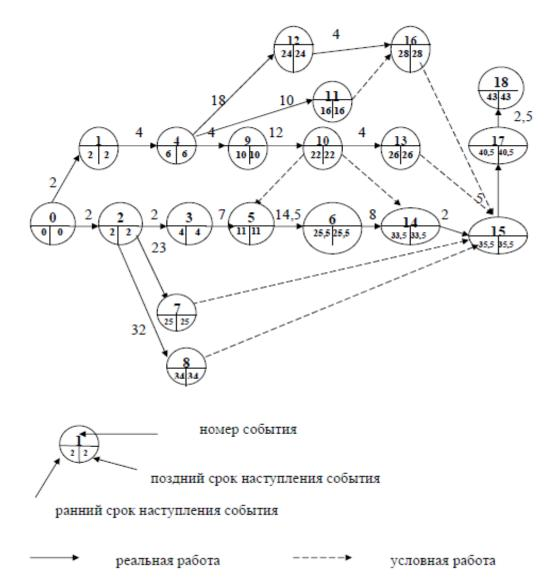
Рис. 1. Типовой сетевой график комплексной подготовки самолета Ил 96-300 в транзитном аэропорту ( $A_{TP}$ )
