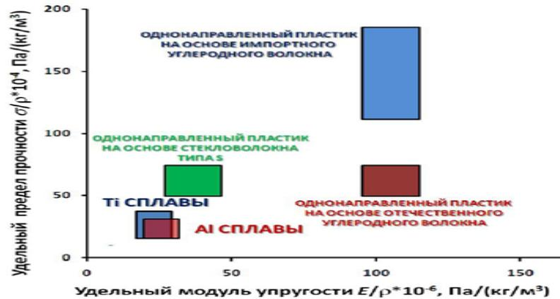
**Рис. 3.** Сравнение удельной прочности ( $\sigma/\rho$ ), модуля упругости ( $E/\rho$ ) углеродных КМ как зарубежного, так и отечественного производства с традиционными конструкционными материалами (Ti, Al, металлические сплавы)
