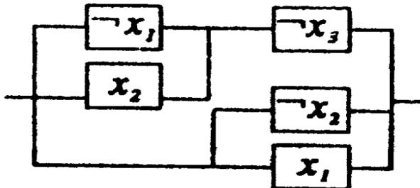
**РЕШЕНИЕ.** При решении задач такого типа следует помнить, что последовательное соединение реле соответствует конъюнкции, а параллельное — дизъюнкции. Полезным является умение преобразовать топологию схемы так, чтобы явно были видны последовательные и параллельные участки схемы. Преобразуем топологию схемы (добавленные участки обозначены пунктиром, удаляемые участки помечены “ $\times$ ”):
