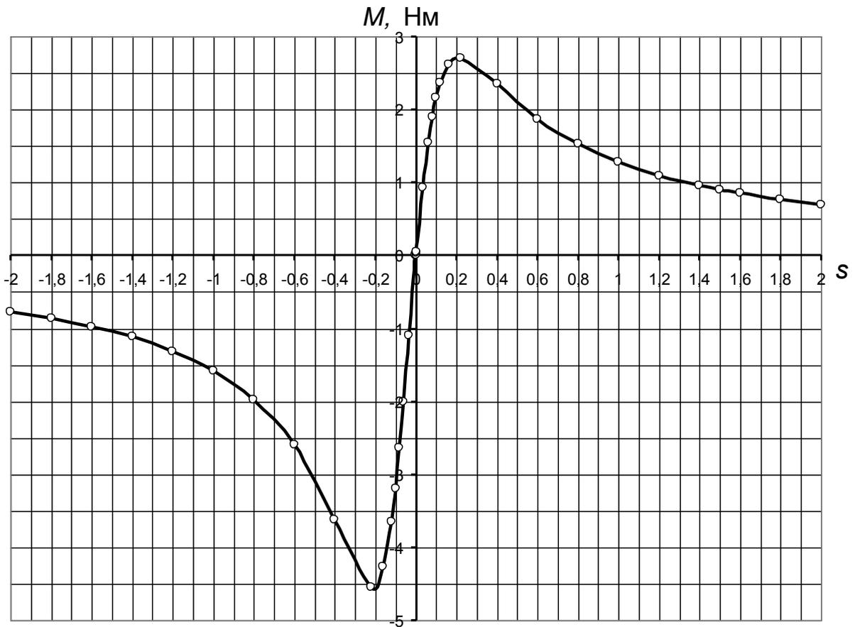
Рис. 8. Механическая характеристика асинхронной машины
