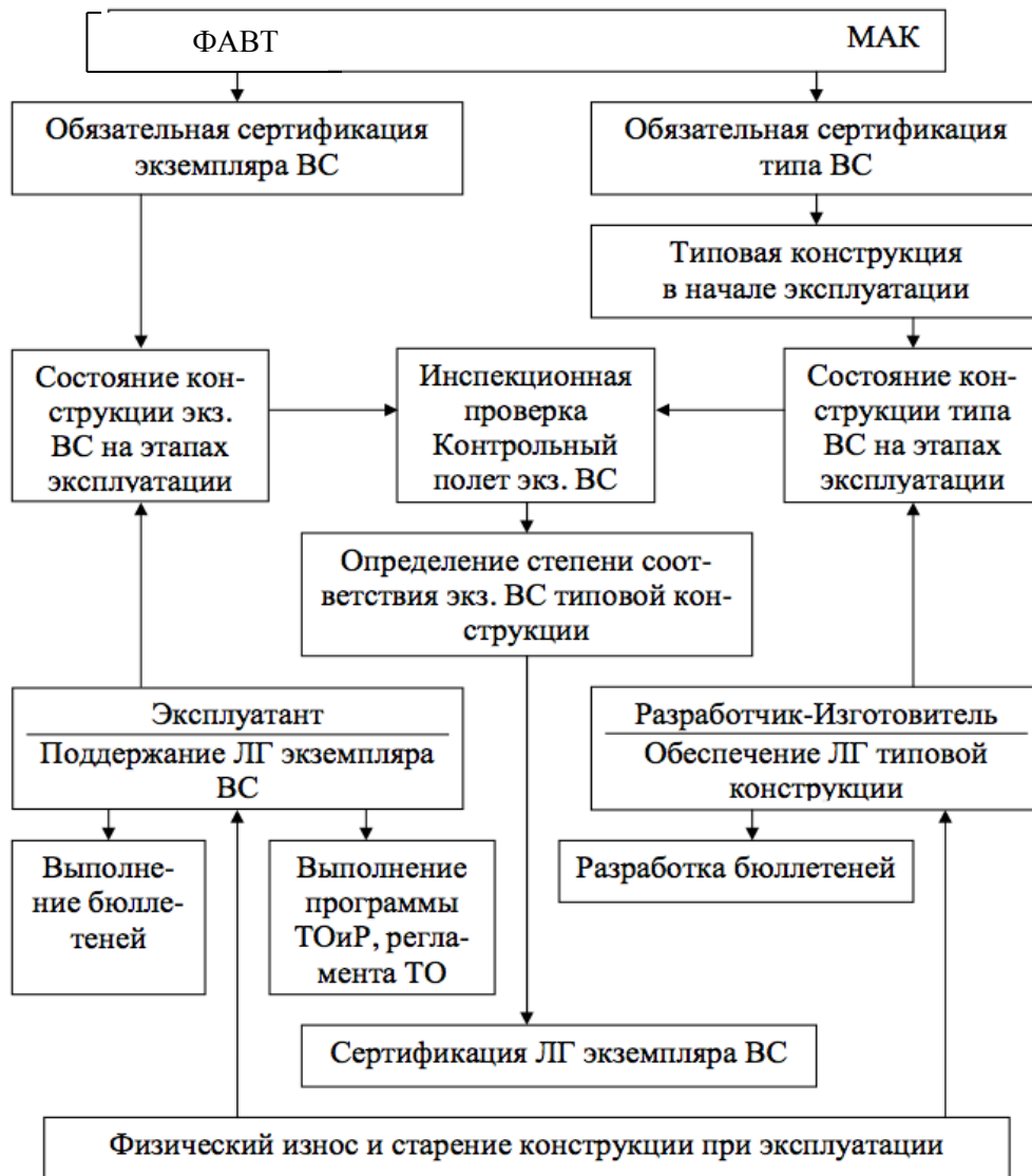
Рис. 2.7. Схема организации государственного контроля за летной годностью ВС на этапах разработки, производства и эксплуатации
