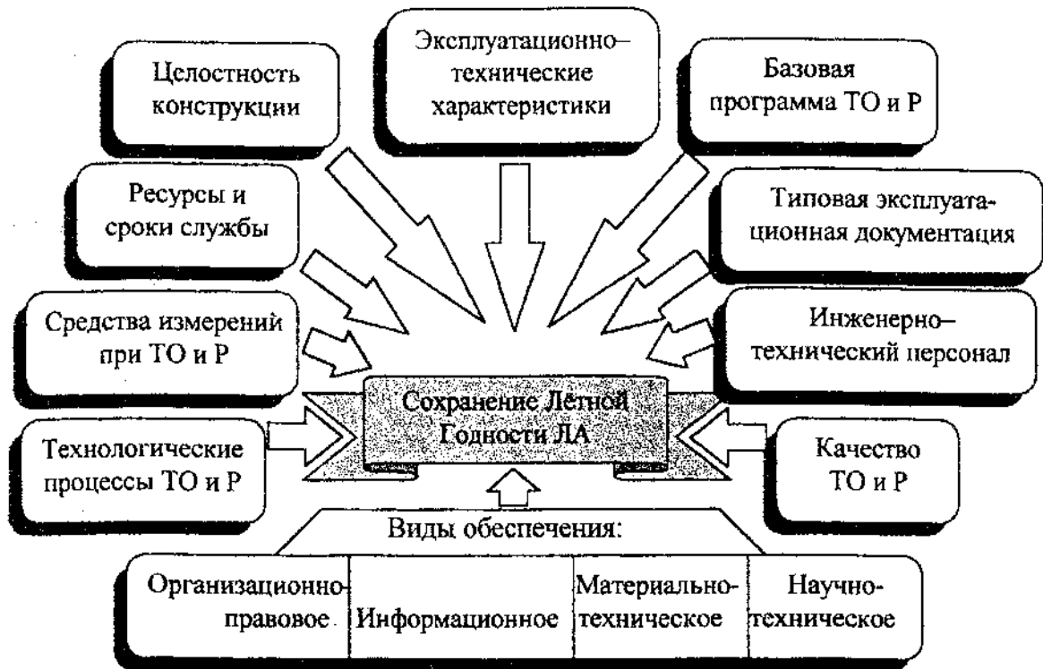
Рис.2.4. Основные факторы, определяющие лётную годность, и виды обеспечения, способствующие её поддержанию при эксплуатации ВС
