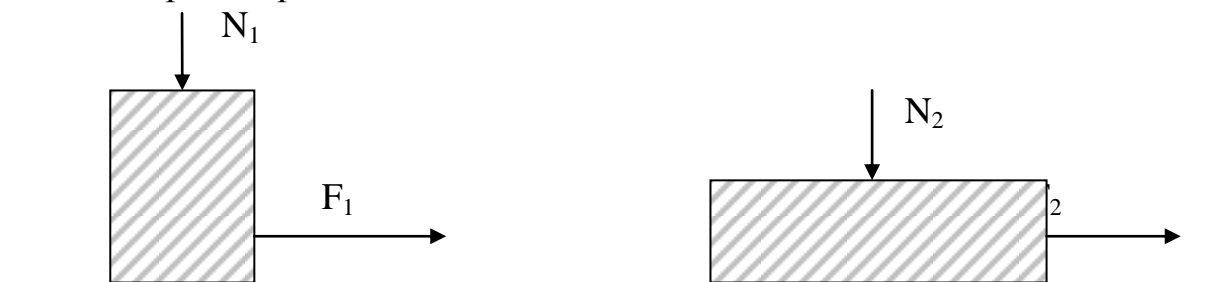
Рис. 4.2. Соотношение между нагрузкой и силой трения
