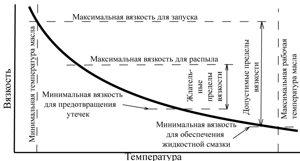
Рис. 4.3. Рабочий диапазон вязкости моторного масла по температуре
