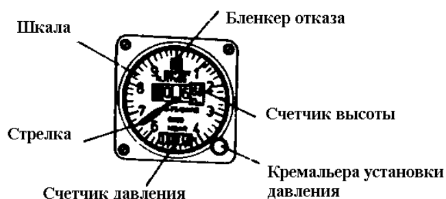
Рис.34. Указатель высоты УВ-75-15ФПБ
