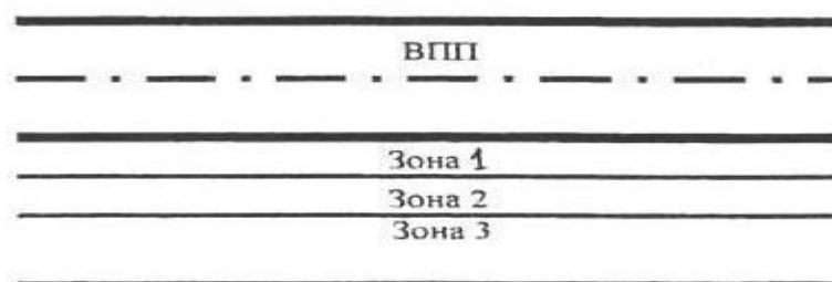
Рис. 2.2. Зона производства работ возле ВПП
