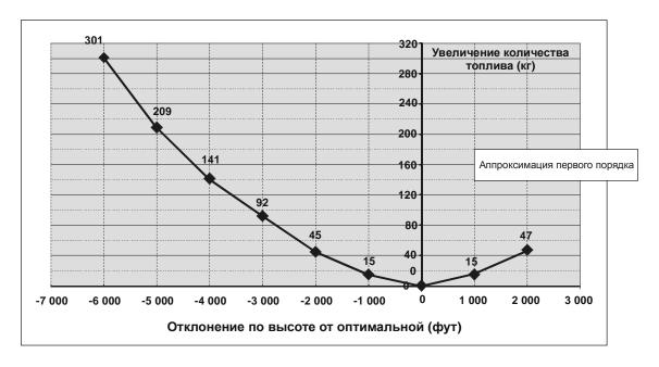
Рис. Н-3. Среднее увеличение количества сжигаемого топлива в час (кг)
