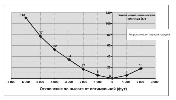
Рис. H-4. Среднее увеличение количества сжигаемого топлива на 100 м. миль (кг)
