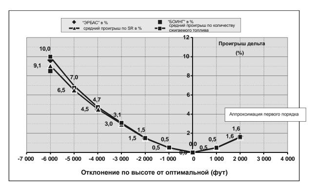
Рис. H-2. Проигрыш по удельному расстоянию и количеству сжигаемого топлива для не оптимальной высоты
