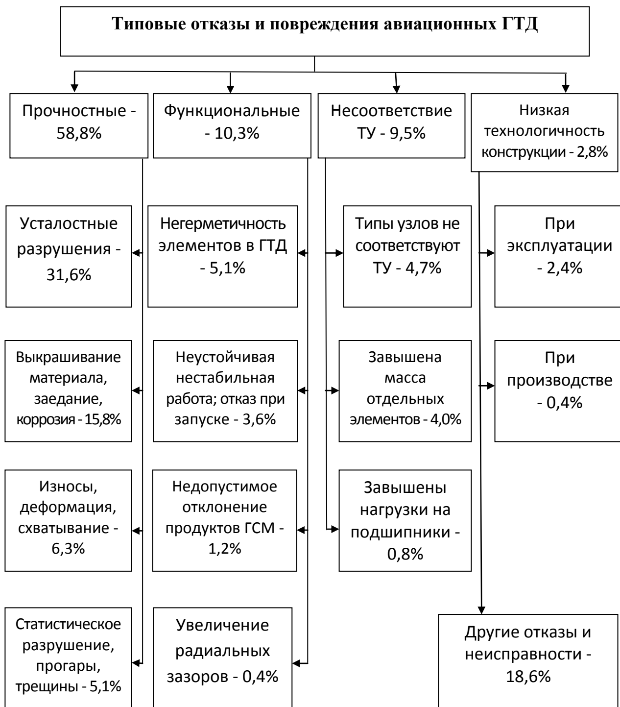
Рис. 8. Классификация основных видов типовых отказов и повреждений ГТД
