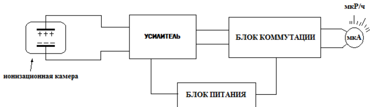
Рис. 3.1. Устройство прибора, работающего на основе ионизационного метода
