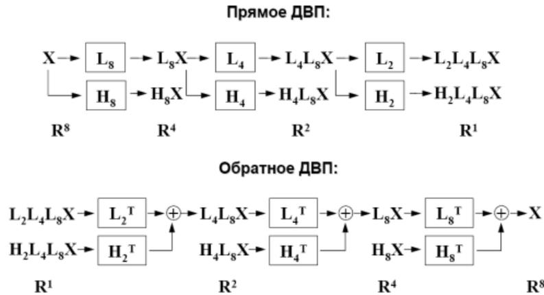
**Рис. 1.** Схема прямого и обратного дискретного вейвлет-преобразования
