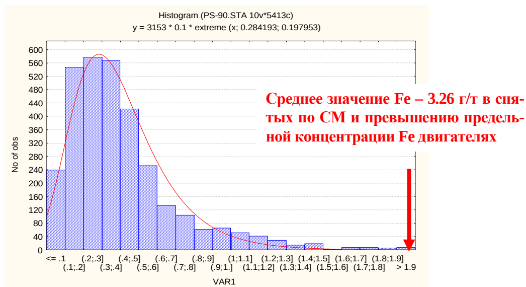
Рис. 1. Распределение Fe в рабочем масле двигателя ПС-90А с фильтром 30 мкм
