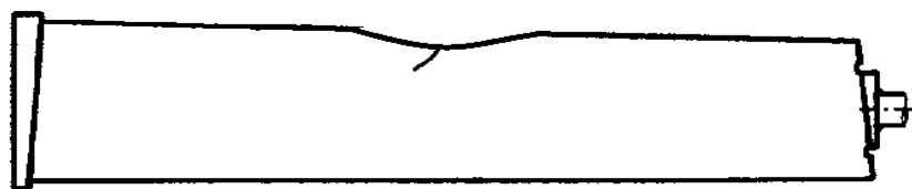
Рис. 8. Трещина по месту ранее выполненной зачистки
