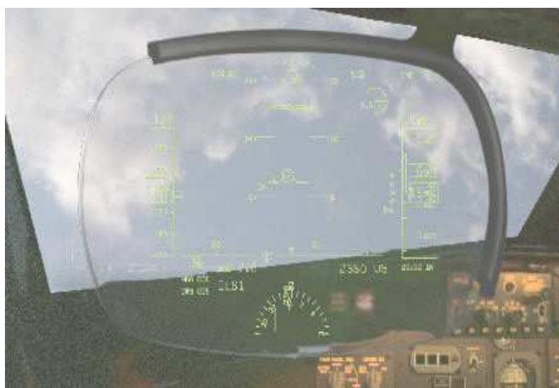
Рис. 3. HUD в составе EVS. Изображение с сайта www.boeing.com
