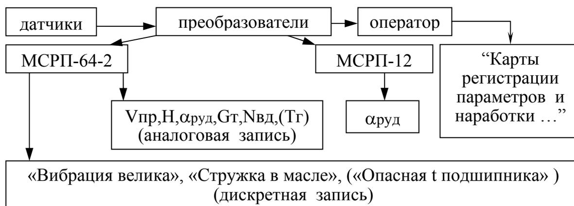
Рис. 26. Схема регистрации параметров ТРДД Д-30КУ
