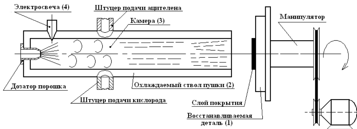
Рис. 10. Схема процесса детонационного напыления
