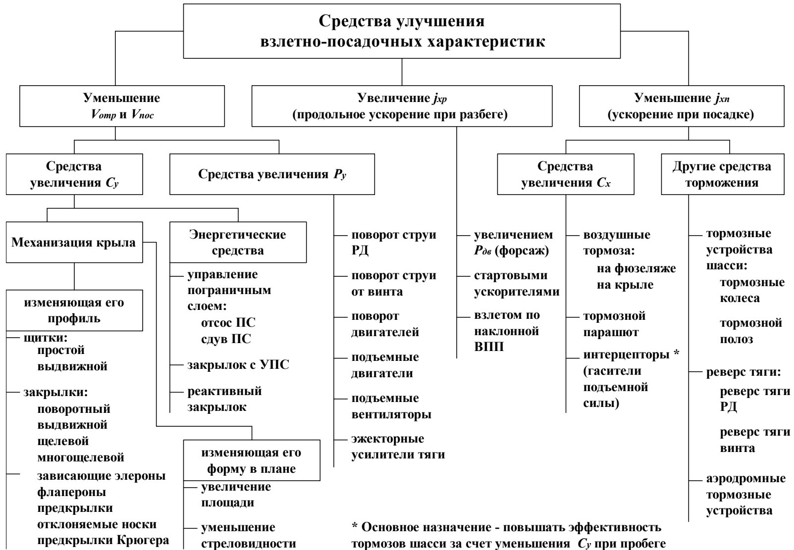
Рис.2.1. Классификация средств, улучшающих взлетно-посадочные характеристики самолетов
