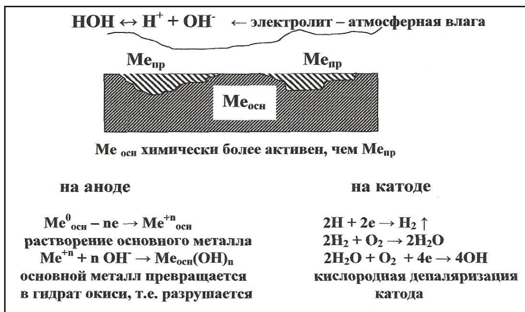
Рис. 11.3.3.4 Механизм разрушающего действия при электрохимической коррозии
