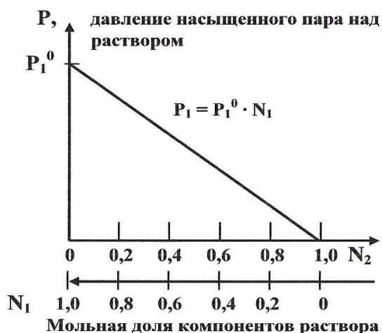
Рис. 8.2.1.1.2 Зависимость давления насыщенного пара растворителя над раствором от концентрации растворенного вещества
