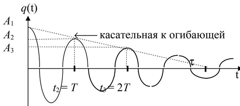
Рис.1. Свободные затухающие колебания заряда конденсатора в контуре
