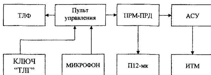
Рис.2.6.Схема проверки и поиска места отказа радиостанции «Микрон»
