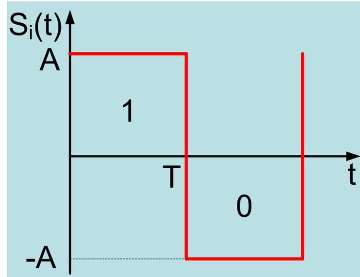
Для систем с активной паузой  $E_{пор}=0$  и оптимальный Алгоритм работы решающей схемы имеет вид:
