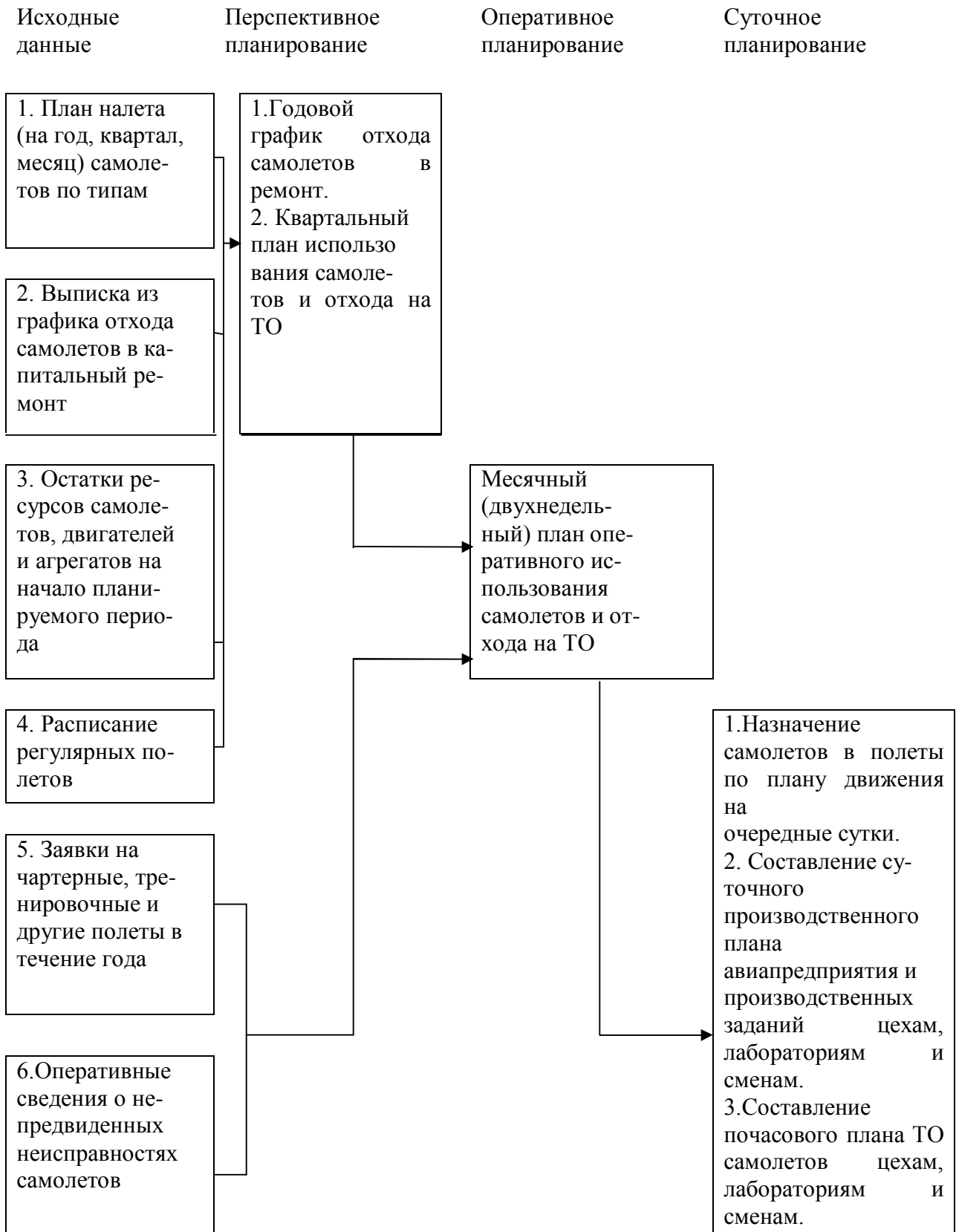
Рис.1 Принципиальная схема планирования использования ТО и ремонта самолетов в авиапредприятии
