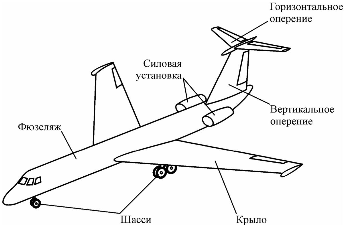
Рис. 9. Общий вид самолета
