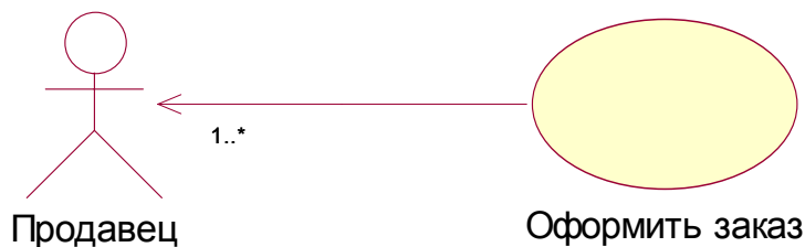
Рис. 5. Пример графического представления отношения ассоциации между актером и вариантом использования
