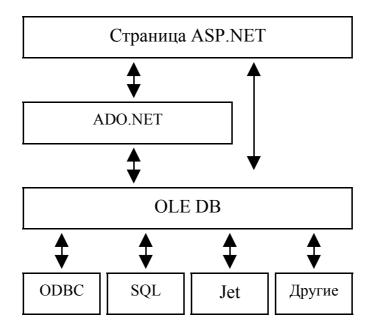
Рисунок 3.3- Модель доступа к данным в ADO.NET и ASP.NET.
