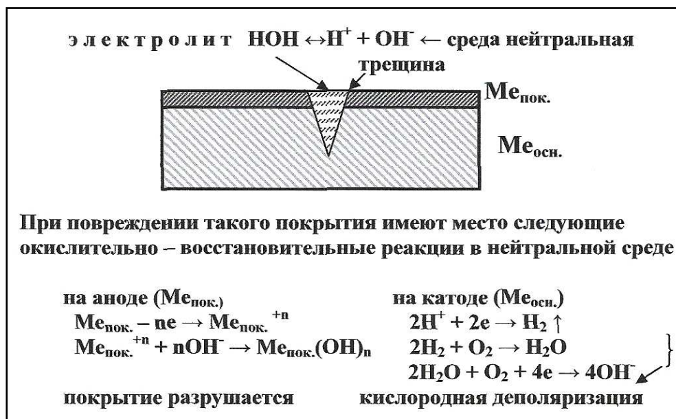
Рис. 11.3.3.5 Механизм защитного действия анодного покрытия
