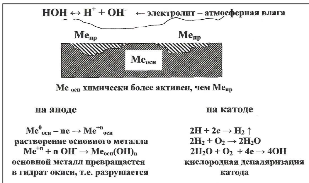
Рис. 11.3.3.4 Механизм разрушающего действия при электрохимической коррозии
