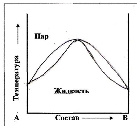
Рис.8.3.7 Диаграмма состояния температура – состав азеотропной смеси двух жидкостей
